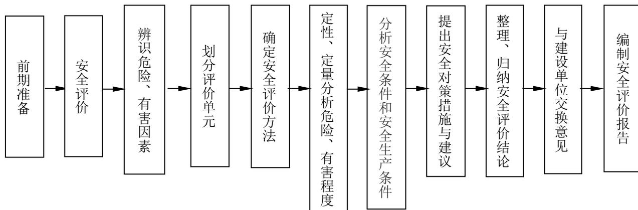
图 1.4-1 安全验收评价程序示意框图
