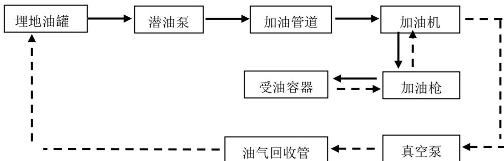
注：虚线箭头表示油气回收工艺路线。
